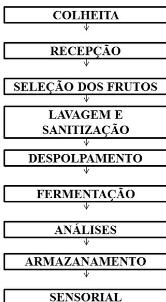
**Figura 2.** Fluxograma da Elaboração da Bebida Fermentada alcoólica.
