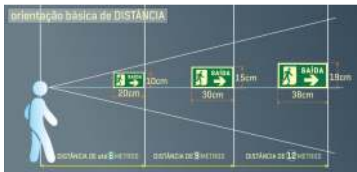
Figura 01: Placas de sinalização de Segurança Contra Incêndio e Pânico
