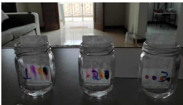
Figura 5. Resultado esperado com o uso do papel filtro e com os solventes na seguinte ordem: Água, álcool e querosene.
