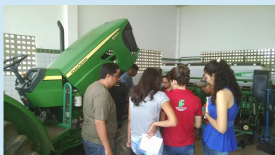
Aula prática na oficina de máquinas e Implementos Agrícolas: sistemas elétrico, hidráulica, de lubrificação e de arrefecimento.
