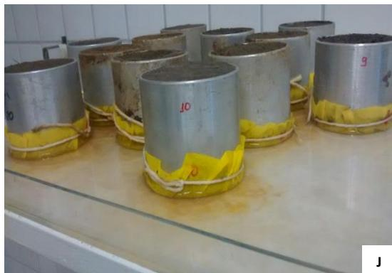
**Fotografias:** Procedimentos metodológicos para caracterização física dos solos como granulometria e estabilidade de agregados pela flocação (f, g e h), porosidade total (macro e micro) pelo método do anel volumétrico em mesa de tensão e densidade do solo (i e j), realizado pelos estagiários bolsistas no laboratório de Agronomia do IF Baiano Campus Lapa.
