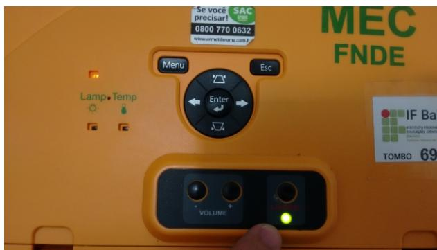
Após desconectar seu equipamento do computador interativo, aperte o botão de desligar.
