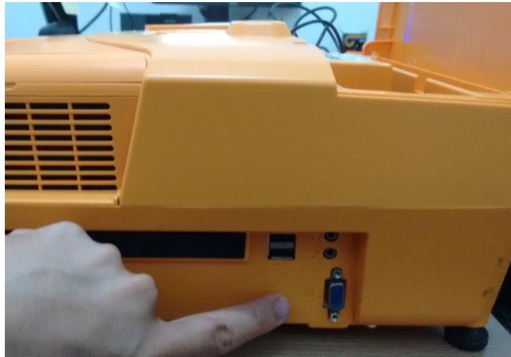
Para usar só a função de projetor, o seu equipamento deve ser conectado via **cabo VGA** na entrada lateral do computador interativo.
