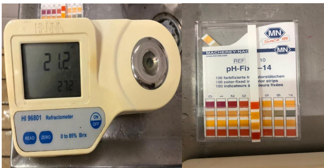
Figura 4: Refratômetro para análise de sólidos solúveis (A) e Fitas de pH (B).
