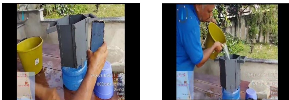
Figura 23- Imagens do aparato desenvolvido no formato sextavado para realização dos testes de permeabilidade em uma única peça.
