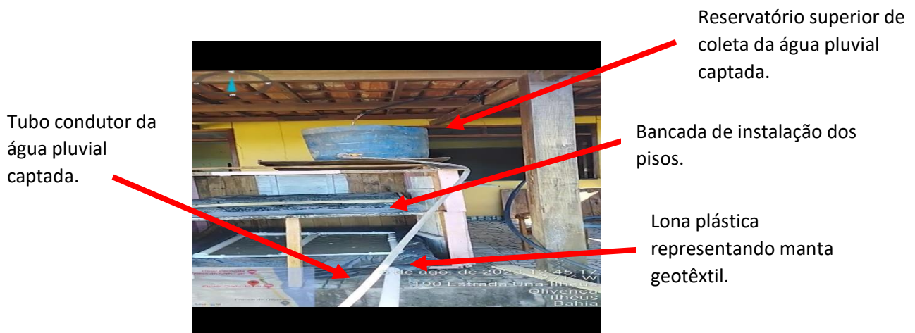
Figura 30 - Água captada pelo sistema hidráulico através de tanque.
