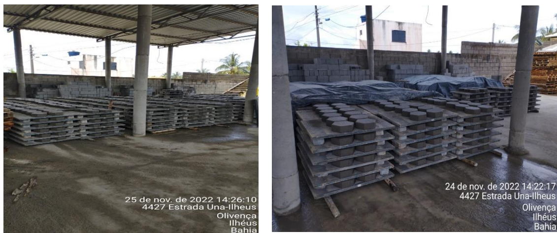
Figura 21 – Processo de cura com lona plástica de coloração escura.
