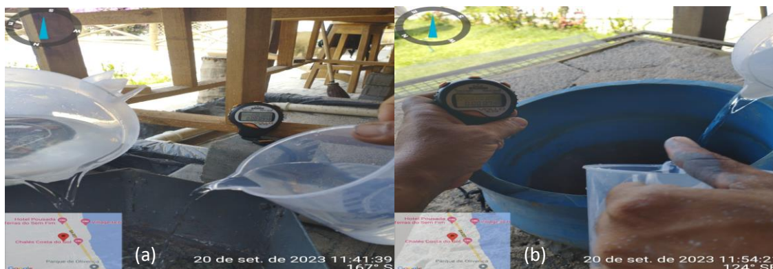
Figura 33 - Testes de permeabilidade no aparato individualizado (a) e em tubo de cor azul na bancada adapta de um metro quadrado de pisos permeável (b).
