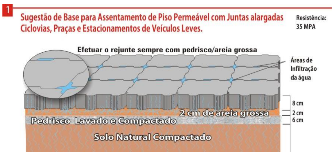
Figura 8 – Base de assentamento de Piso Permeável. Fonte: Gráfica Rogel.
